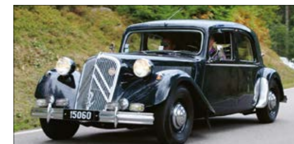
Baujahr 1952 · 2,8-Liter-Reihensechszylinder · 77 PS Jean-Michel Deltgen (LUX) / Norbert Eicher (LUX)
